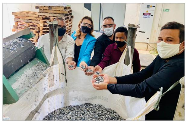
k) galpão de reciclagem de termoplásticos: Área de 200m2 com isolamento acústico e destinada à reciclagem de termoplásticos, considerando a classificação, limpeza, trituração e embalagem dos mesmos. O ambiente possui como equipamentos 01 moinho (para trituração), 05 bancadas (para limpeza), 01 esteira magnética (limpeza final dos grãos) e 01 palleteira
